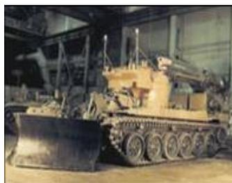
Il sistema robotizzato più efficace, capace di svolgere un grande numero di lavori complessi determinati dall'esplosione della centrale di Chernobyl è costituito dall' assieme di due macchine e viene identificato come complesso di ingegneria robotica Klin-1.
